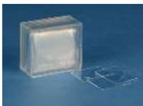
**Lamelle couvre-objet optiquement planée pour cellule de numération. Epaisseur 0,4mm**
