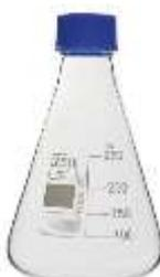
**Erlenmeyer avec bouchon à vis (joint PTFE), col étroit, gradué, en verre borosilicaté. Conforme DIN 12380, ISO 1773**
